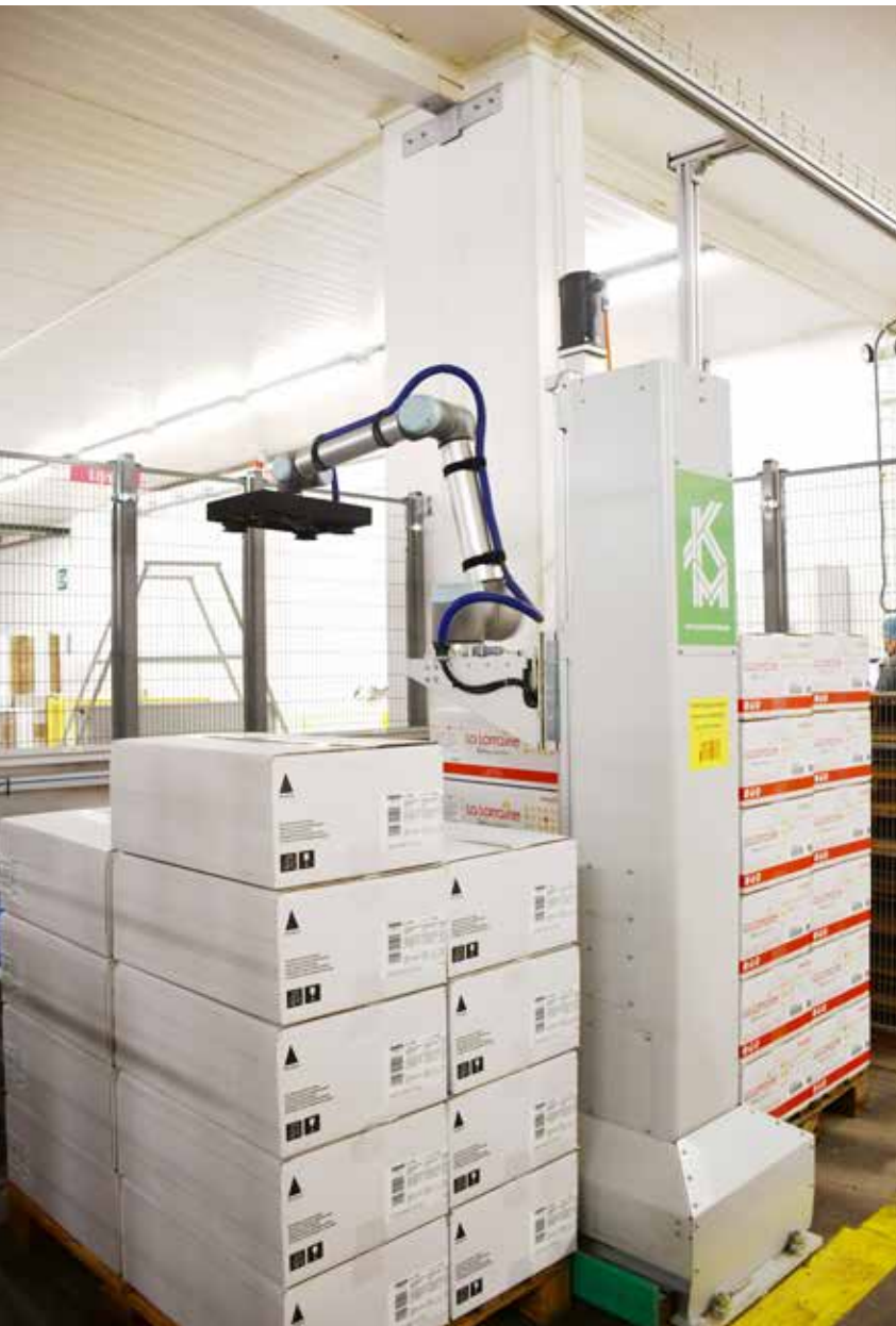
De cobot moest vanuit zijn cel van met beperkte footprint twee lijnen kunnen bedienen en uiteraard aan alle veiligheidsvoorschriften voldoen. Een kolfje naar de hand van KoMotion.
